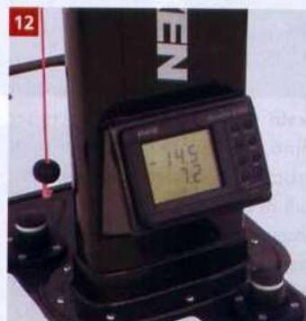
destra sinistra) e drizze. **12** Ripetitore B&G situato alla base della colonnina del caffè in cui si visualizza per il randista e il timoniere l'angolo del trim tab e l'inclinazione della barca. Il monitoraggio continuo di questi valori è importante per mantenere il giusto assetto dell'imbarcazione
